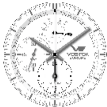
Abb. 12 - Zeigerpositionen im Chronographen-Modus
